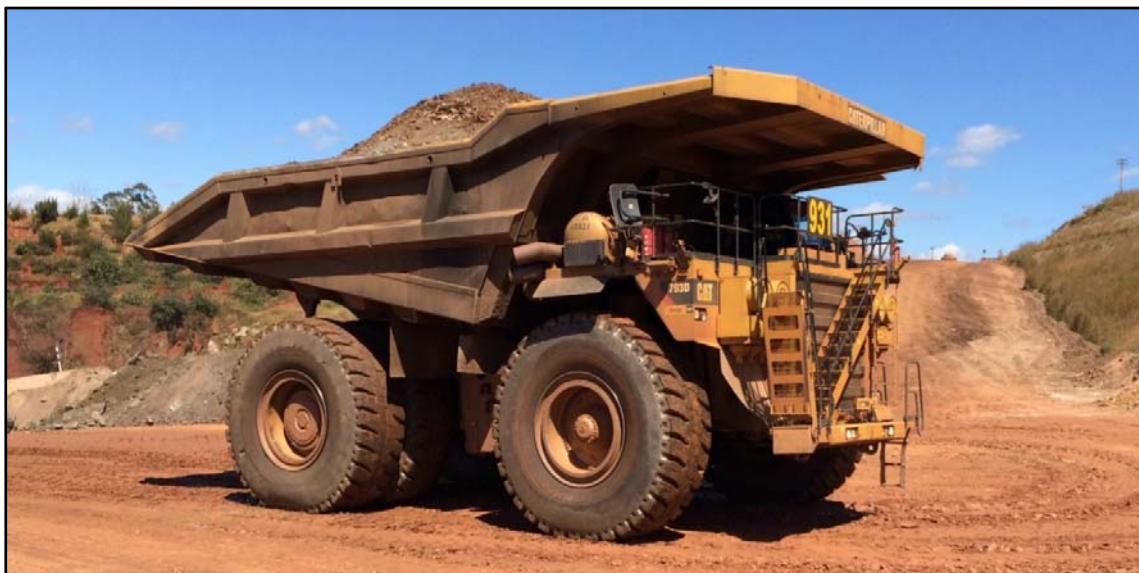
Figura 2. Camión CAT 793D comúnmente usado en la minería brasileña a cielo abierto.
