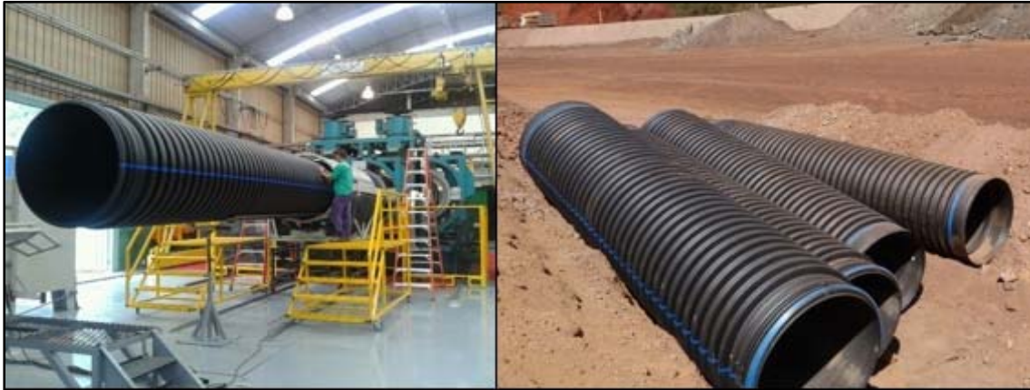
Figura 3. Fabricación y disposición en obra de los geotubos PEAD corrugados.
